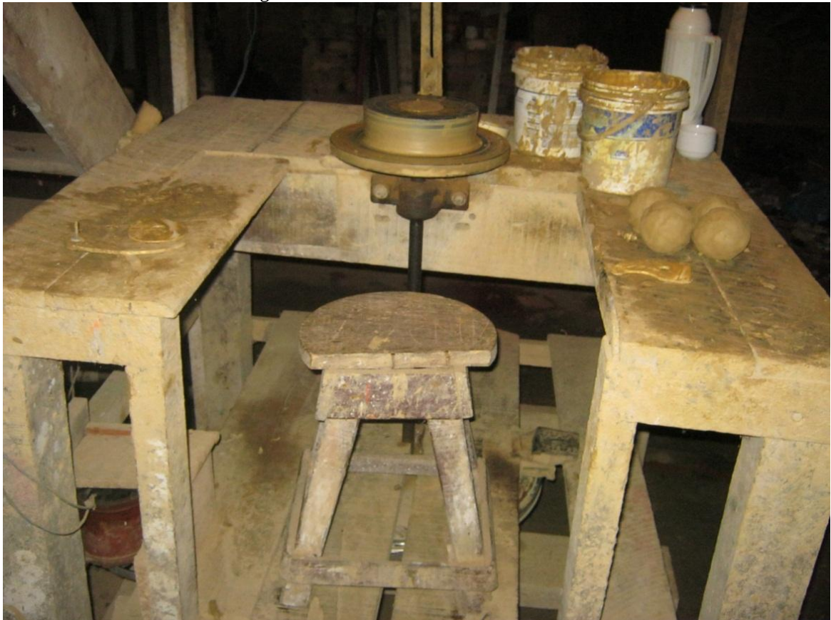
Fotografia 8 - Torno de bancada ou torno de chute
