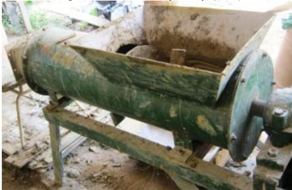
Fotografia 5 – maromba construída por Henoque (artesão)
