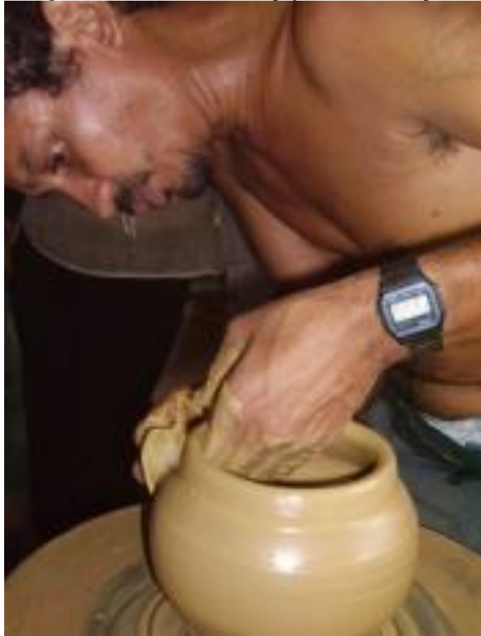
Fotografia 7 – Oleiro levantando a peça com as mãos e palheta
