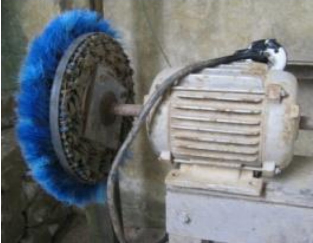
Fotografia 10 – Brunidor feito de motor de máquina de lavar e escova de enceradeira
