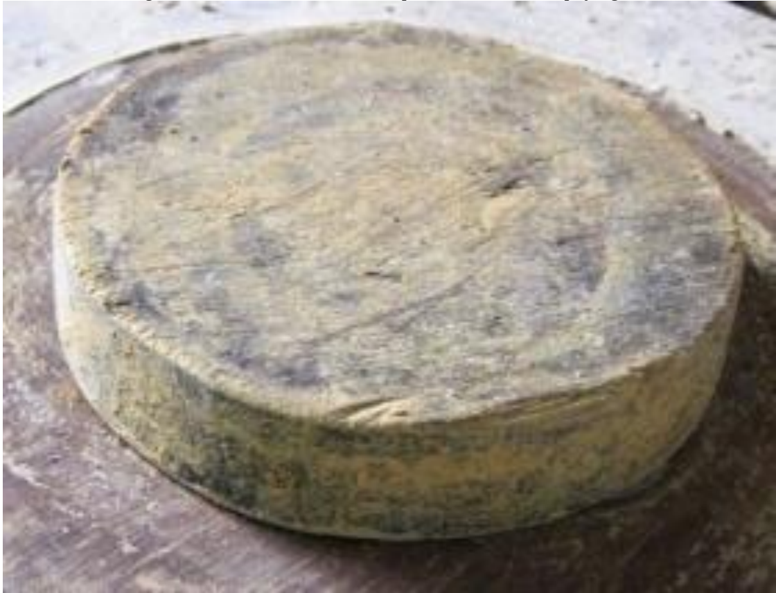
Fotografia 9 - Piota: rodela de madeira para levantamento de peças grandes
