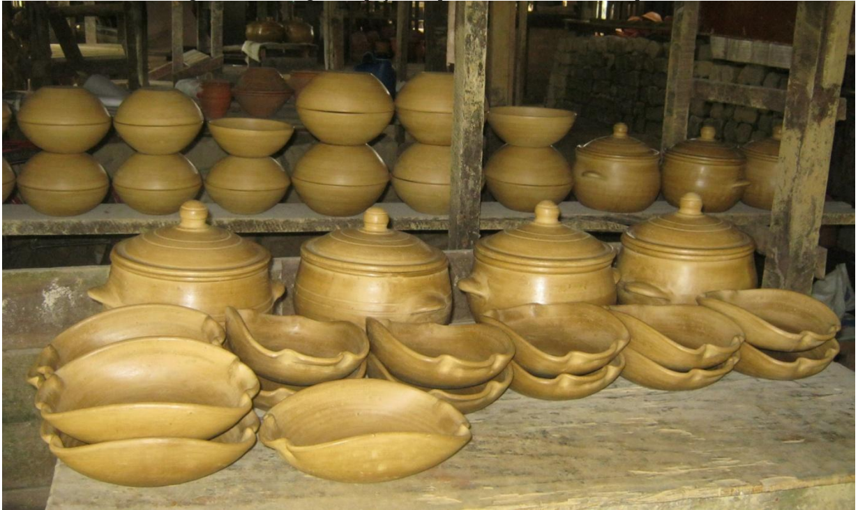
Fotografia 14 - Secagem de peças em prateleiras na olaria dos espanhóis
