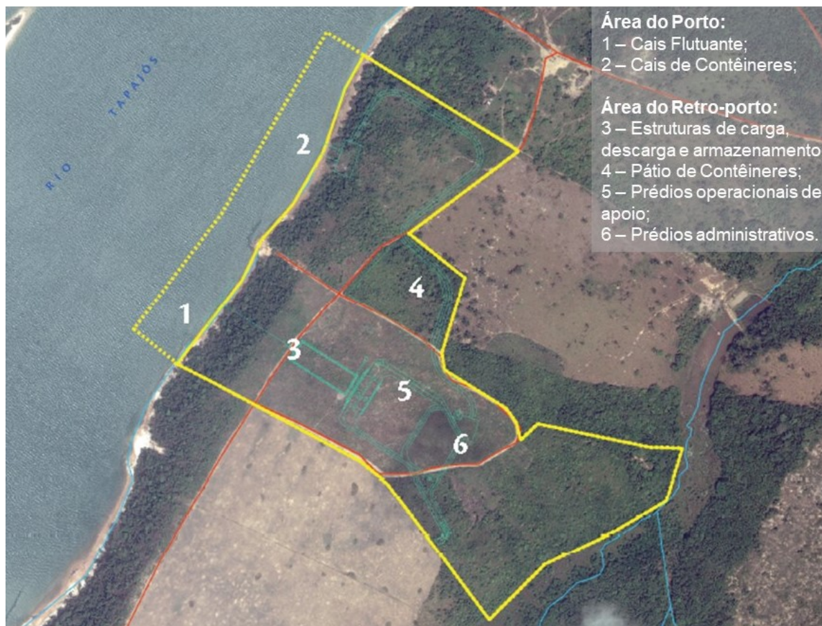
Figura 56 – Desenho (layout) estrutural da ETC Itaituba com a identificação das áreas do porto e do retro-porto
